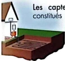
Les capteurs enterrés horizontaux sont constitués de tubes en polyéthylène et sont installés en boucles fermées dans lesquels circule de l'eau glycolée.
